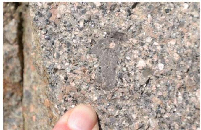
**Figure 3 :** Gros plan sur un prisme de rhyolite « ignimbritique » de Saint-Victor-sur-Rhins très riche en cristaux. On reconnaît les différents minéraux (quartz, feldspath, quelques micas noirs) inclus dans une « pâte » vitreuse amorphe contenant aussi des microcristaux. On peut noter la présence d'une enclave sombre de composition basaltique, preuve qu'un (faible) magmatisme basique (pauvre en silice) est associé au magmatisme acide (riche en silice) dominant. © Pierre Thomas
